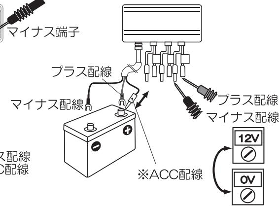
・常時電源（ボルト）はACC配線の接続に関係なくバッテリー電圧と同等の電圧になる
