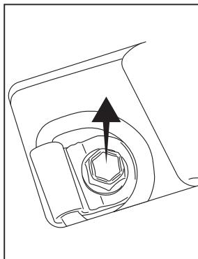
④付属のノブボルトとワッシャーを使用して、フレームを車体に2ヶ所固定します。このとき、ボルトは②で設置したスペーサーの中を通すように取付けてください。
