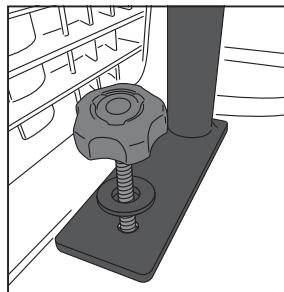
②カーペットを内側に折り込み、ネジ部が見えるようにします。ネジ部の上には、2ヶ所ともスペーサーを配置してください。
