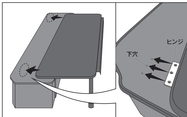
②トラスティングねじを使用してヒンジを固定します。サイドボックスは木製のため、ねじの締めすぎには注意してください。
