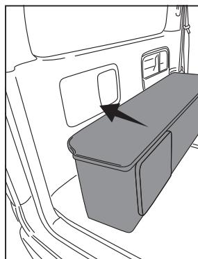
②カーペットを内側に折り込み、ネジ部が見えるようにします。そのネジ部の上に、2ヶ所ともスペーサーを配置してください。
