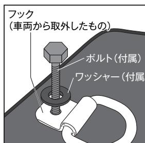
③カーペットを内側に折り込み、ネジ部が見えるようにします。そのネジ部の上に、4ヶ所すべてにスペーサーを配置してください。また、スペアタイヤのアクセボルト周辺のカーペットも同様に折り込み、キャップが付いている場合は取外します。
