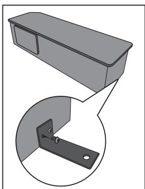
⑥より強固に固定したい場合や、①で取外したフックを再利用したい場合は、ノブを使用せず、ボルトとワッシャーを使って締め付けてください。この方法で固定する場合は工具が必要になりますので、事前に準備しておいてください。
