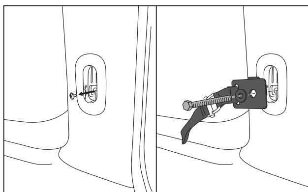
④フリップベッドの脚を展開・格納する際は、脚部左側にあるロックレバーを押してロックを解除してください。展開後および格納後は自動でロックがかかります。脚を出さずにベッドを展開すると破損の原因になりますので、ベッドを使用する際は必ず先に脚を出してください。
