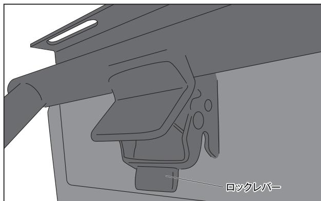
⑤フロアパネルを使用しない場合は、脚部先端のアジャスター ポルトを伸ばして、フリップベッドが水平になるように調整します。ロックナットを緩めることで調整が可能です。位置が決まったら、ロックナットを締めてしっかりと固定してください。
