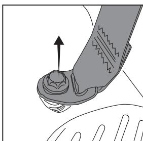
⑥取外しておいたフック、付属のワッシャーとボルトを使用して、フロアパネルを4ヶ所固定します。
