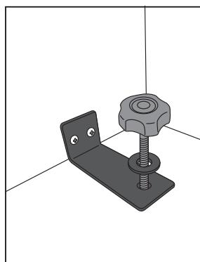
③トラスタッピングねじを使用して、サイドボックスの右側面にL字アングルを取り付けます。取付けの際は、あらかじめ開けられた下穴に合わせて固定してください。
