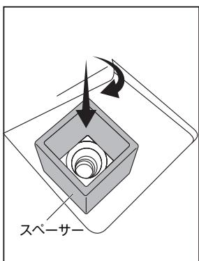
⑤付属のノブボルトとワッシャーを使用して、サイドボックスを車体に2ヶ所固定します。(③で取付けたL字アングルと、サイドボックスの扉を開けた内側に付いているアングルです。)このとき、ボルトは②で設置したスペーサーの中を通すように取付けてください。
